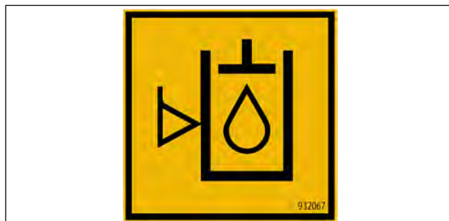
Figura 32: Autocolant - Nivel de ulei hidraulic
