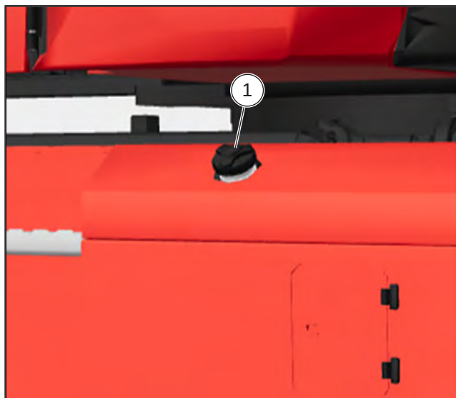
Figura 208: Umplerea rezervorului de combustibil
