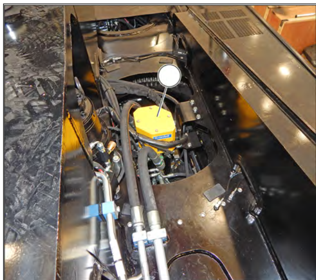
Figura 307: Verificarea și curățarea inelelor emițătorului pentru colectorul electric rotativ
