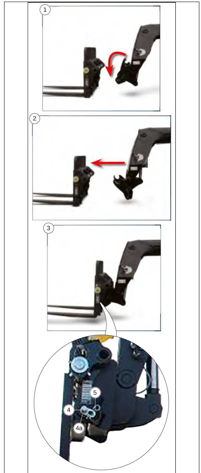
Figura 211: Remontarea accesoriului cu dispozitivul de blocare manuală
