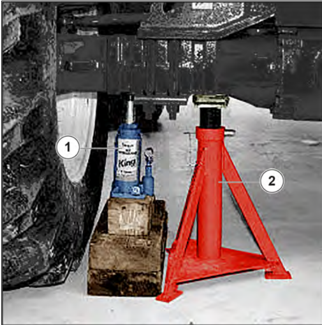
Figura 294: Utilizarea unui dispozitiv de ridicare și a unui suport de siguranță (exemplu)
