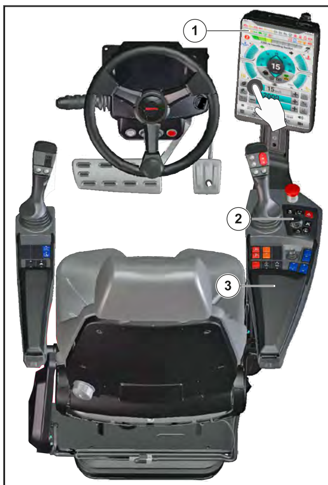
Figura 120: Mod de control afișaj
