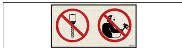
Figura 50: Autocolant - Avertisment - dispozitiv ROPS/FOPS montat, nu găuriți și nu sudați
