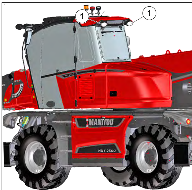
Figura 182: Lumini de lucru cu LED în partea din față și din spate a cabinei
