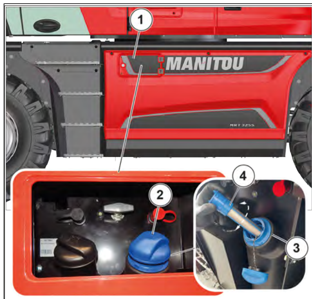
Figure 308: Verificarea și curățarea filtrului de umplere a rezervorului def
