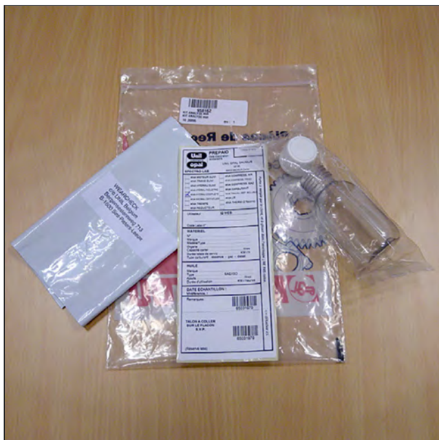
Figura 261: Verificarea contaminării uleiului hidraulic
