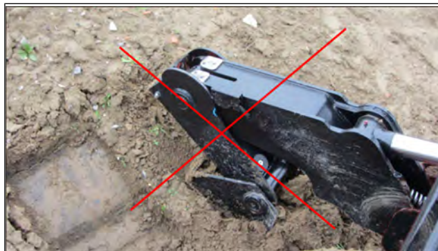
Figura 224: Verificați deschiderea sau extensia corectă a stabilizatoarelor.
