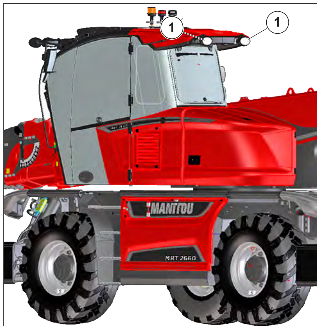
Figura 184: Lumini de lucru cu LED în partea din față și din spate a cabinei
