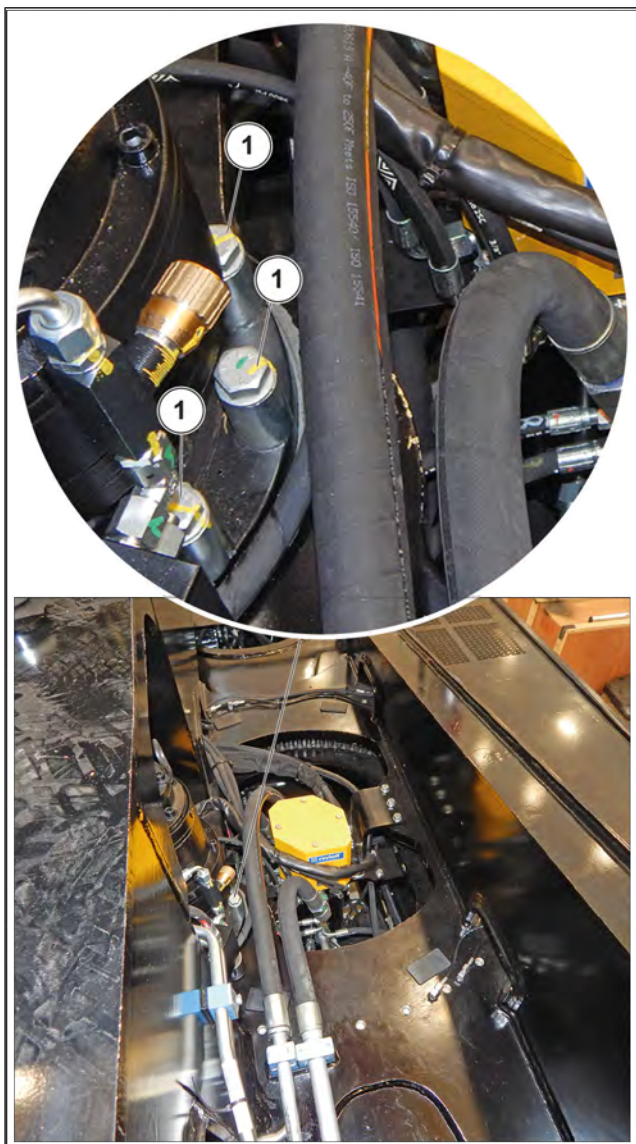
Figura 255: Verificarea etanșeității șurubului de fixare a reductorului de rotație
